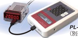
SPD-24 | プログラムローダ(設定器) SPDL-24 | *データロギングや給電は不可
